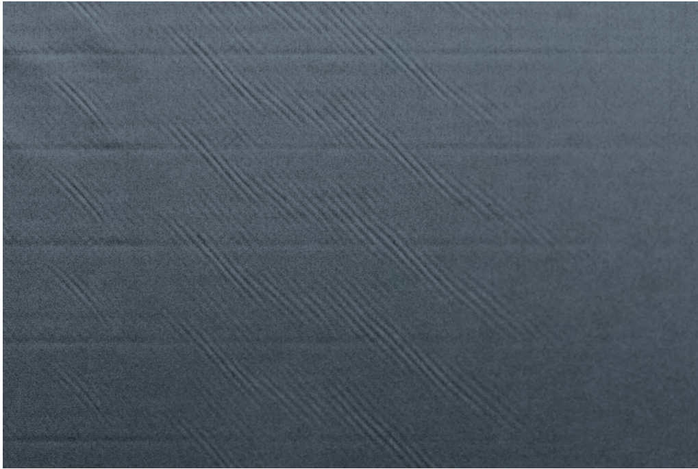
Bild 9.4.4 Querabdrücke durch die Anbindung an die Tuchwelle und sich abzeichnende Quernähte können im Tuch sichtbar sein, siehe 4.2.7
