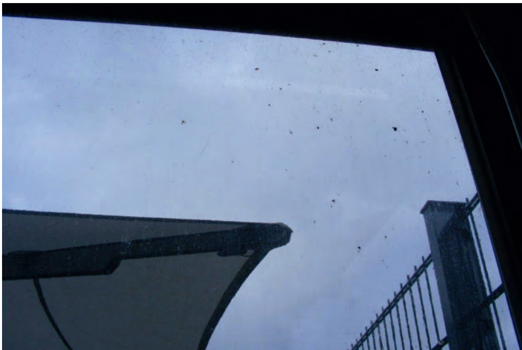
Bild 9.4.5 Am PVC-Sichtfenster können sich Schleif- und Kratzspuren einprägen und Querstreifen entstehen
