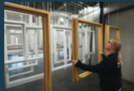
Das **innerbetriebliche Kreislaufsystem** sorgt für die nachhaltige Nutzung von Materialien. Verschnitt von Kunststoffprofilen wird wieder zu Grundmaterial gemahlen und fließt so unternehmensintern in einen Kreislauf echter Wiederverwertung beim selben Produkt. Im Holz-Alu Werk installierte ACTUAL eine Hightech-Oberflächenanlage mit einem speziellen Lack-Rückgewinnungssystem.
