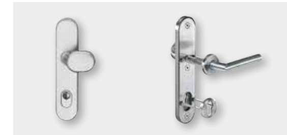
AI 69 E UND A70 E + 69 E Edelstahl (E) Kombi-Sicherheitsgarnitur: außen Langschild, innen Rosette, ES1 geprüft, RC 2 geeignet. Kernziehschutz, außen gehärtete Stahlunterkonstruktion G 238
